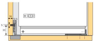
Сборка монтажной планки: 33 мм от переднего края шкафа Наложение 14,5 мм для дистанции 3 мм и расстоянием до чашки С 4,5 мм
